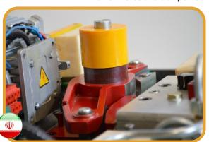
ماشین سوزن الکتروهیدرولیکی از نوع دومحوره با قفل داخلی و سیستتم سازگاری با فشار معکوس چرخ های واگن توسط این شرکت بر اساس استاندارد SIL4 طراحی و تولید گردیده است.
